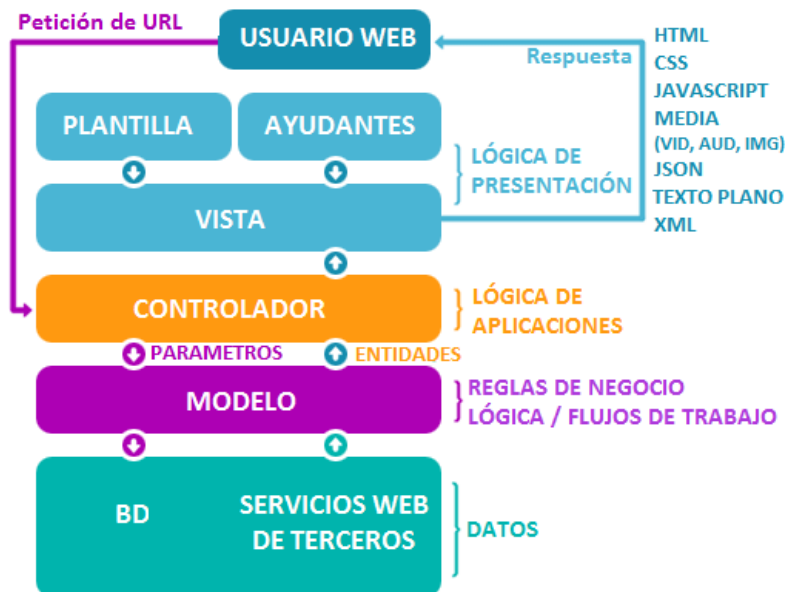
Figura 5.6: Componentes de una aplicación web basada en Ruby on Rails
