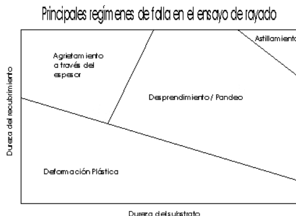
Figura 13. Mapa de los principales modos de falla en términos de la dureza del sustrato y del recubrimiento.
