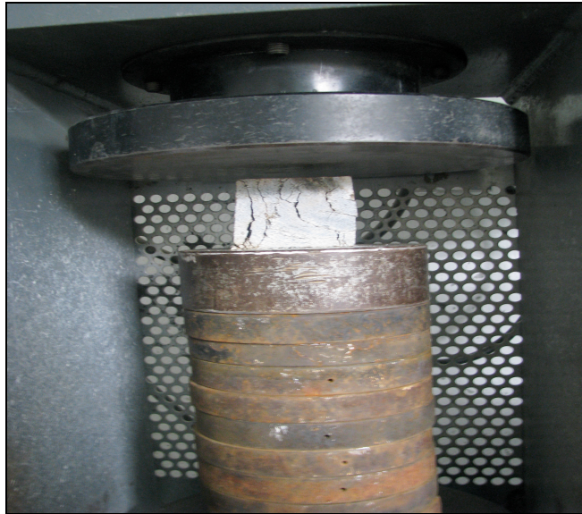
Foto N° 1: Prensa para ensayo de compresión uniaxial.
