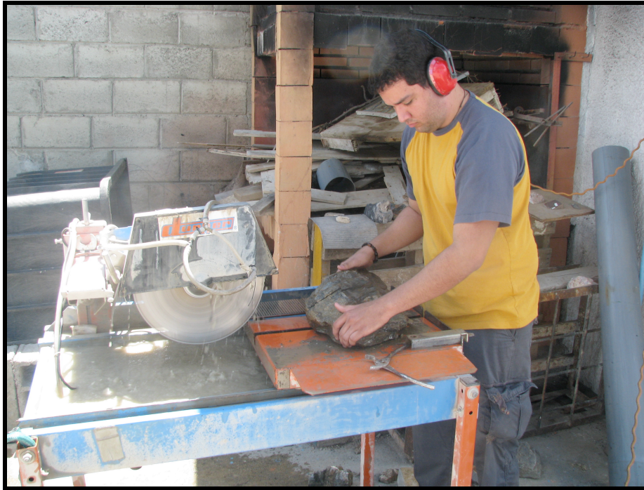
Foto N° 2: Preparación de muestra cúbica
