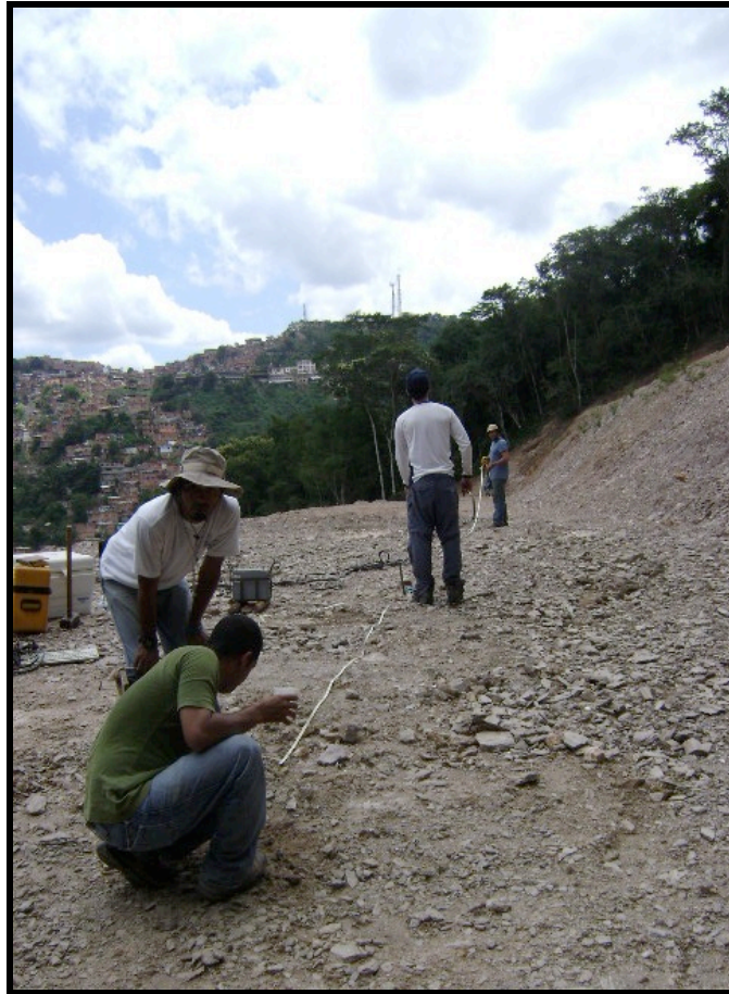
Foto N° 9: Preparación de un tendido de refracción sísmica e implementos asociados.
