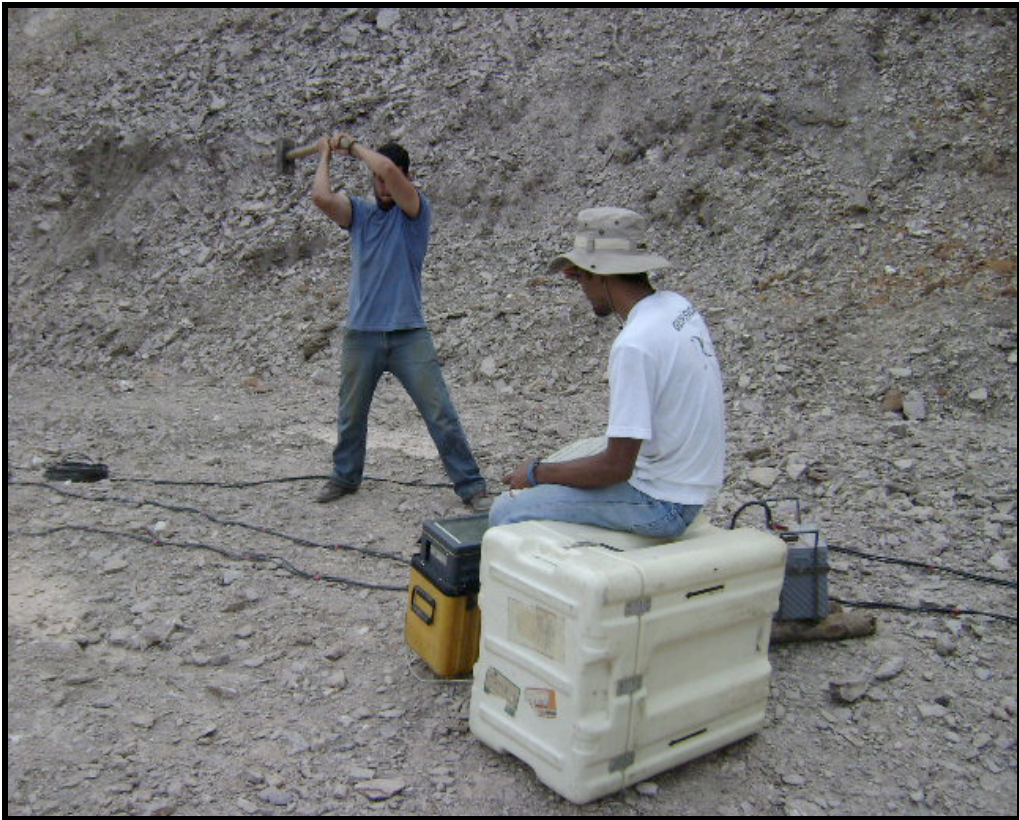
Foto N° 10: Generando ondas P.
