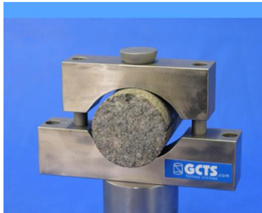
Figura 30. Prensa de carga para ensayo de tracción indirecta.
