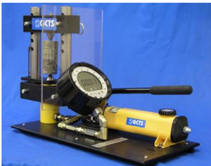
Figura 18. Equipo para la realización del ensayo de Carga Puntual.
