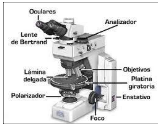
Figura 35. Microscopio petrográfico. Mod. Olympus CDX10. Laboratorio de petrografía Ígneo metamórfica. Departamento de Geología, UCV.)
