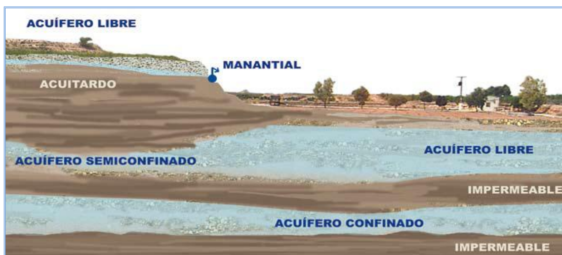
Figura 11. Tipos de acuíferos en función de la presión hidrostática del agua contenida en ellos (López et al., 2009).
