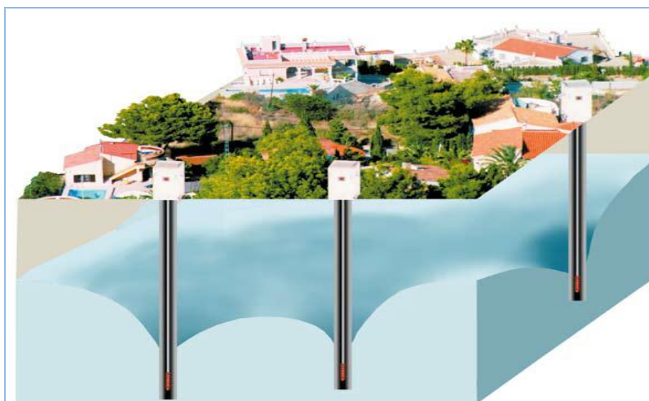
Figura 16. Ilustración de la interferencia entre pozos cercanos. (López et al., 2009)
