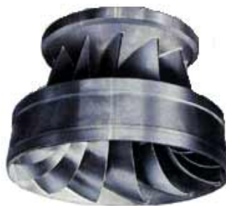
Figura 16. Rodete de una Turbina Francis
