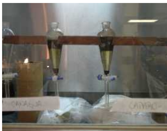
Figura 2.6. Método de separación de minerales pesados mediante Bromoformo
