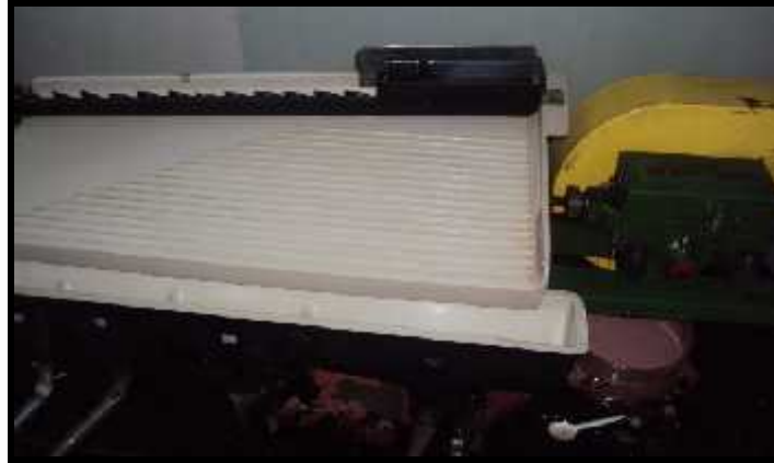
Figura 2. 2. Mesa de Wilfley ubicada en el Laboratorio de Termocronología de la UCV
