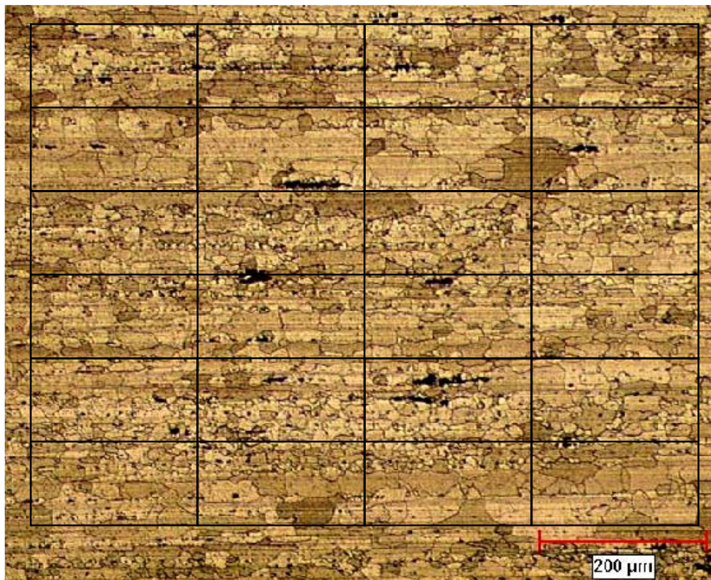
Fig 10. Modelo de malla con segmentos horizontales y verticales empleados para la determinación del tamaño de grano de las muestras.
