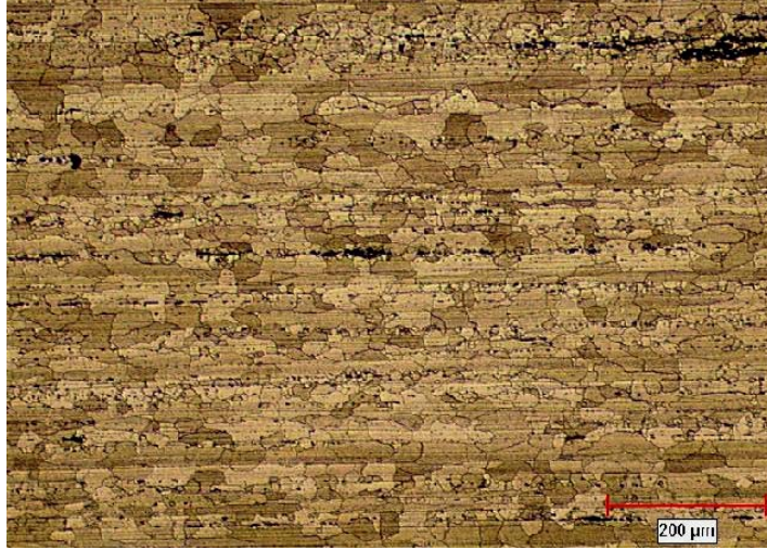
Fig 15. Fotomicrografía por microscopía óptica de una muestra de aleación 7075-T735 recocida a 415°C, deformada 60% y recocida a 480°C por 30 minutos, tamaño de grano promedio 26μm (100X).
