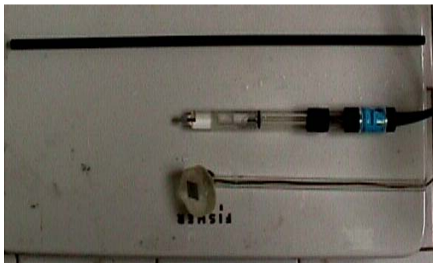
Fig 12. De arriba hacia abajo; contraelectrodo de grafito, electrodo de calomel saturado y electrodo de trabajo.
