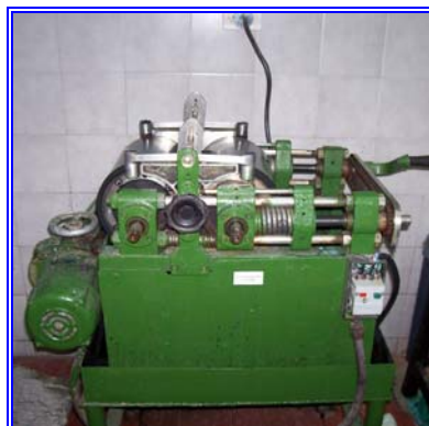
Figura N° 13. Fulard para la impregnación de químicos y colorantes. (Fuente T.P.G.)
