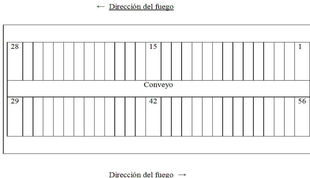
Figura 2.8 Esquema de la ubicación de las 56 secciones en horno I y la dirección de los fuegos.
