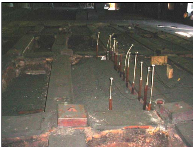
Figura 3.4 Ubicación de las termocuplas en la fosa de prueba
