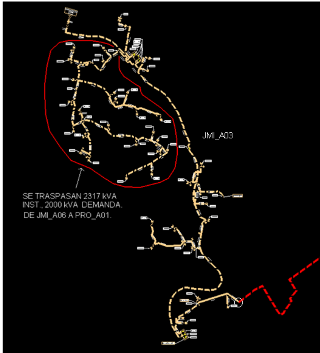
Figura 5.21. Traspaso en proyecto de JMI_A03 hasta PRO_A01
