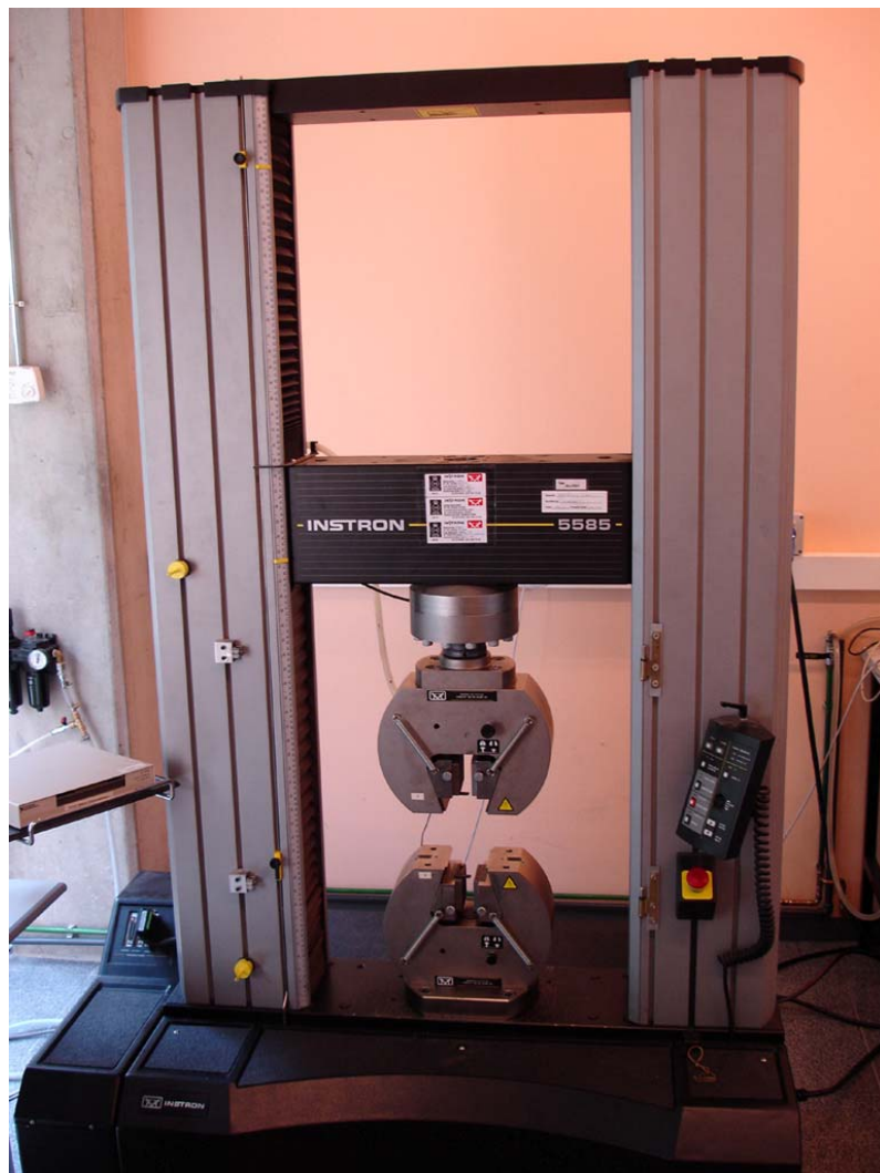
Figura 1.19 Máquina universal de ensayos mecánicos, Instron 5585.
