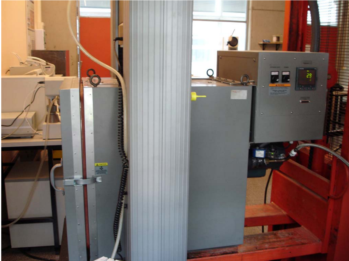
Figura 1.20 Cámara ambiental, Eurotherm MTS Systems Corporation, modelo 651.06E-03.
