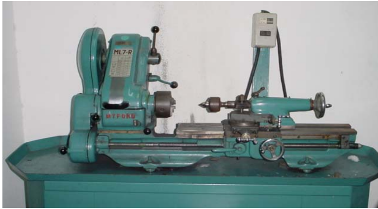
Figura 2.3 Torno Myford modelo ML7-R.
