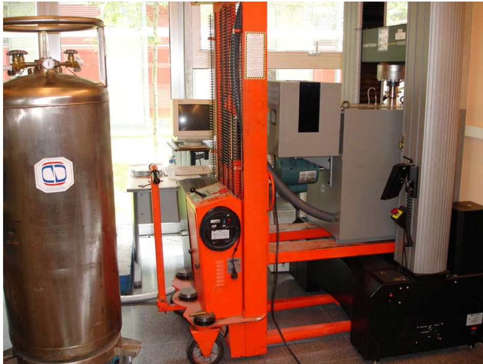
Figura 2.4 Máquina universal de ensayos mecánicos, Instron 5585, con el montaje de la cámara ambiental, Eurotherm MTS Systems Corporation 651.06E-03.
