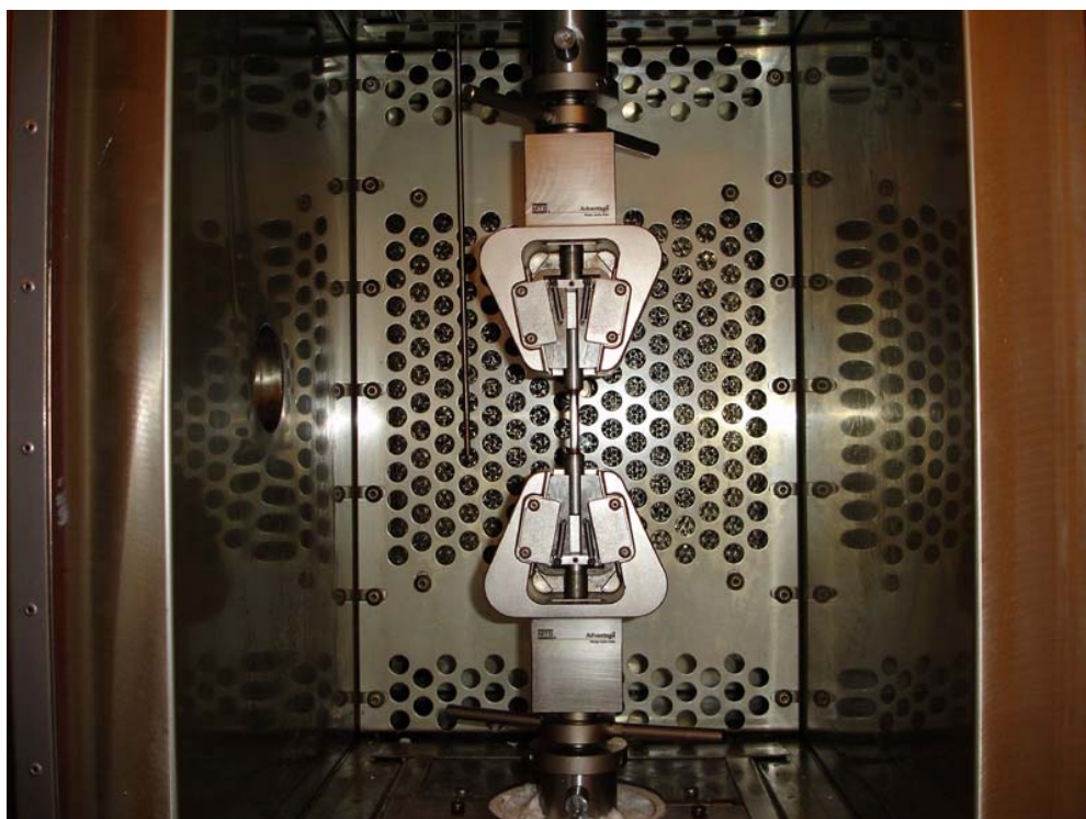
Figura 2.6 Montaje de las probetas dentro de la cámara ambiental Eurotherm MTS Systems Corporation 651.06E-03.
