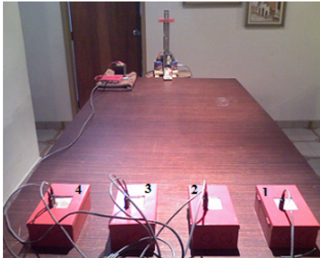
Figura 9.11. Arreglo de geófonos sobre el banco de pruebas.
