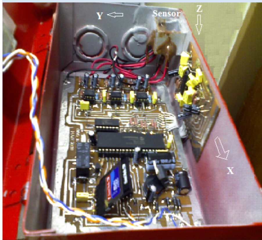
Figura 6.7. Geófono SAPOST internamente.
