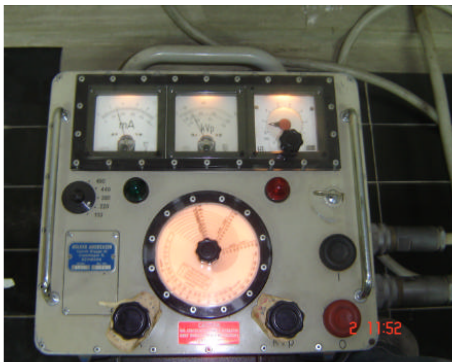
Fig. 19 Tablero de control del Equipo de Rayos X.
