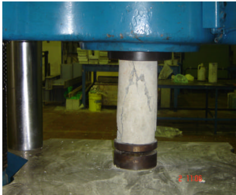
Fig. 15 Ensayo de compresión
