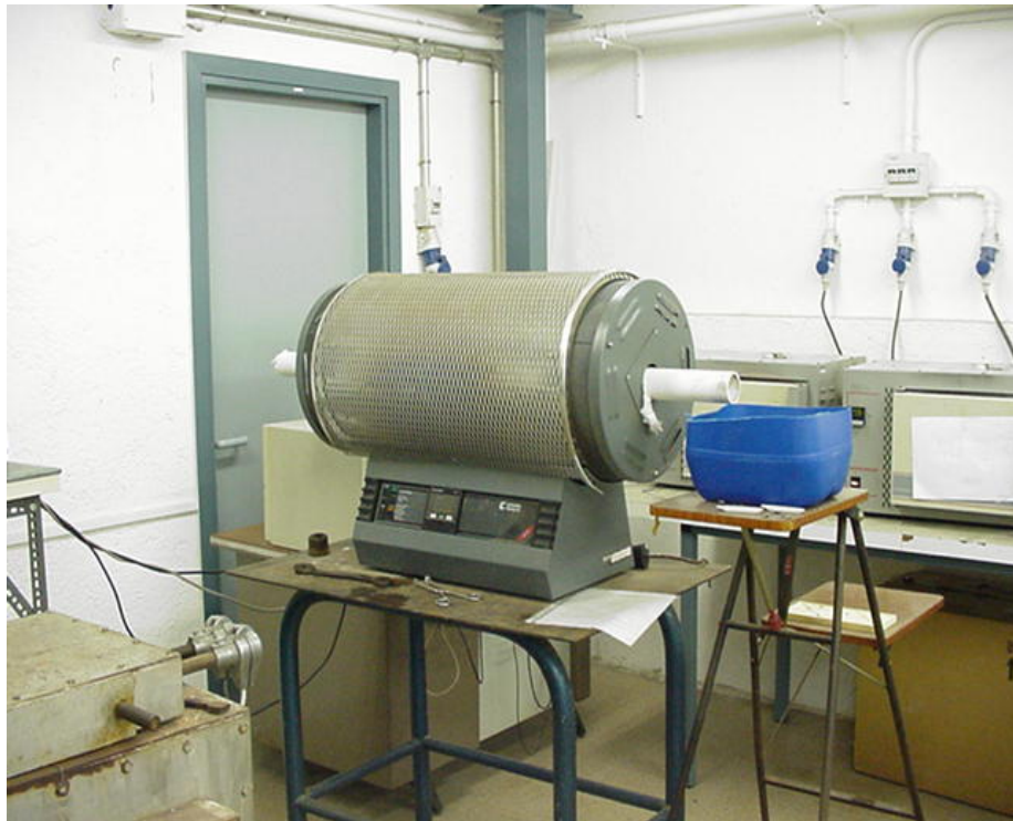
Figura 4. Horno tubular de atmósfera controlada empleado en el tratamiento de homogeneización de las muestras.
