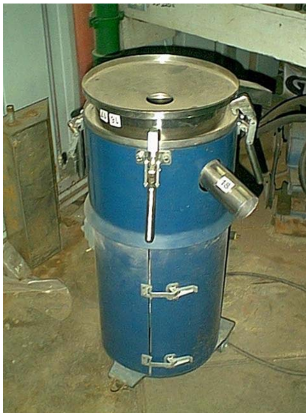
Figura 3.8: Tamizadora Vorti-SIV, utilizada en el SASMP.
