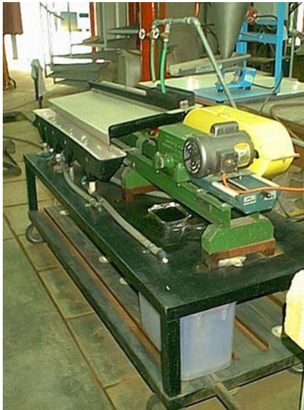
Figura 3.3: Mesa Wilfley usada para la concentración de minerales
