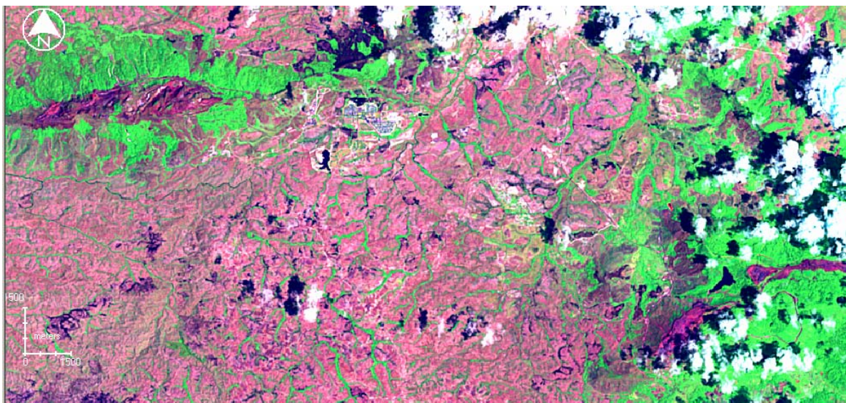
Fig. N° 49: Combinación de las bandas 5-4-2, donde se puede apreciar el realce de colores rojos en el Cerro Bolívar (esquina superior izquierda) y el Cuadrilátero San Isidro (esquina inferior derecha) Escala 1:100.000
