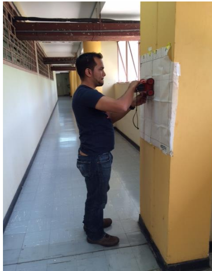
Figura 4.18. Ferroskan. Sondeo Con Radiografía Columna 1P2
