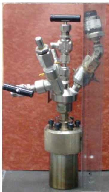
Figura 15. Reactores de acero inoxidable 316 de 75 mL tipo Batch utilizados en las simulaciones. En la parte superior se puede observar las distintas válvulas y el transductor de presión.
