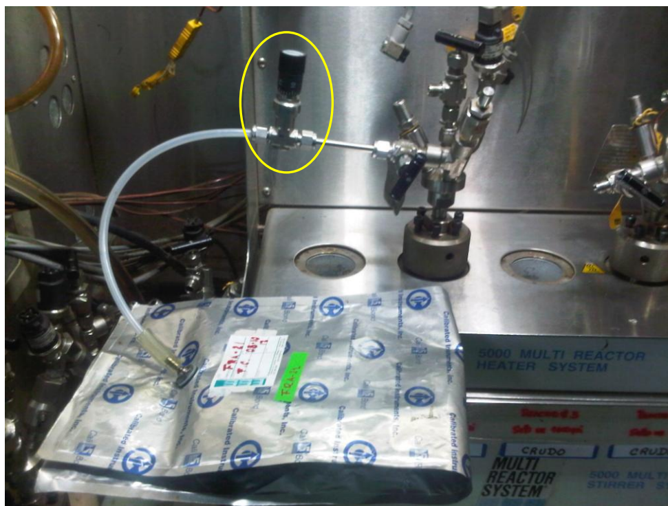
Figura 19. Montaje utilizado para la recolección de las muestras gaseosas. La llave micrométrica utilizada para regular el flujo de gas que sale del reactor se encuentra resaltada. El gas era conducido por el tubo de teflón hasta la bolsa, para después ser analizado.
