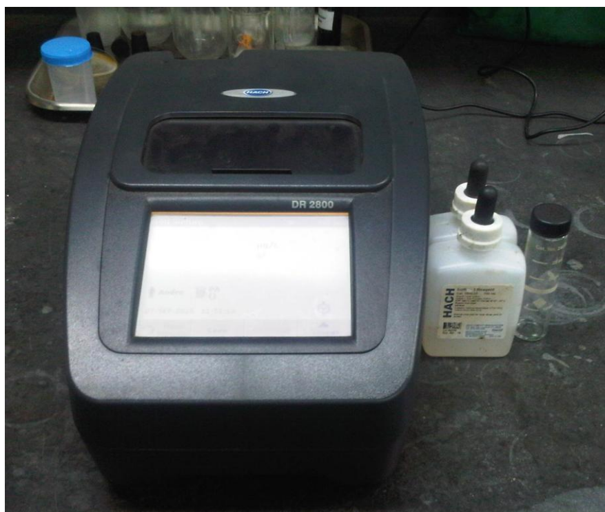
Figura 20. Equipo Hatch DR2800 utilizado para determinar el sulfuro presente en las muestras acuosas. En la imagen se observa también el envase de los reactivos utilizados y el recipiente empleado para la medición.
