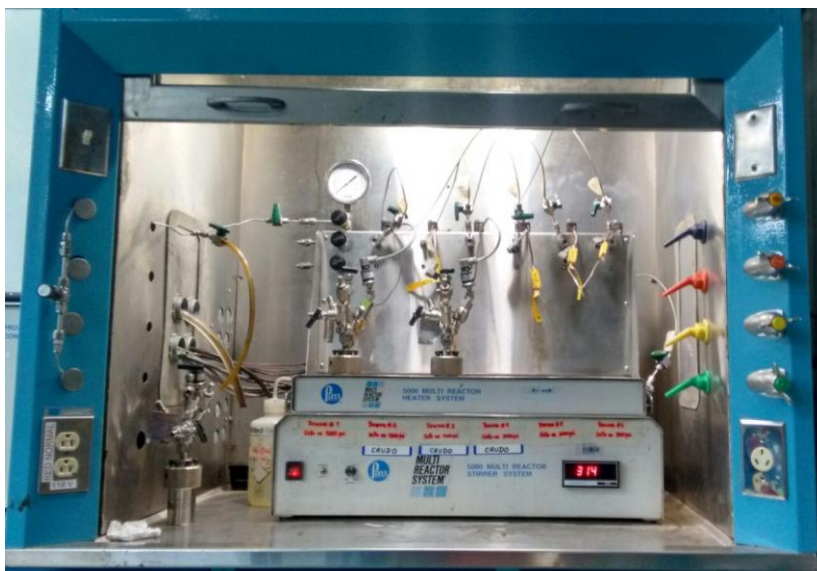
Figura 16. Reactores dentro del equipo multireactor Parr 5000 durante el transcurso de una prueba.
