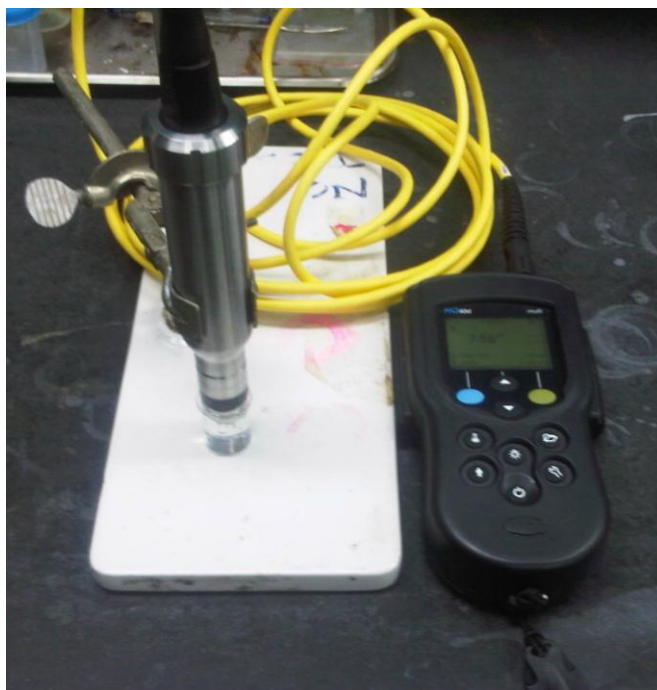
Figura 21. Medidor multiparamétrico Hatch HQ40D utilizado para la medición de pH.
