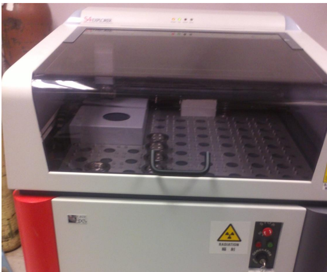
Figura 14. Equipo de Fluorescencia marca Bruker modelo S4 Explorer utilizado para la determinación de las concentraciones de vanadio y níquel.
