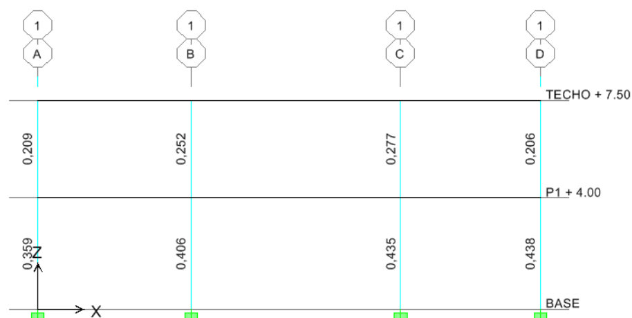
Figura 166. Relación Demanda/Capacidad columnas. Pórtico 1
