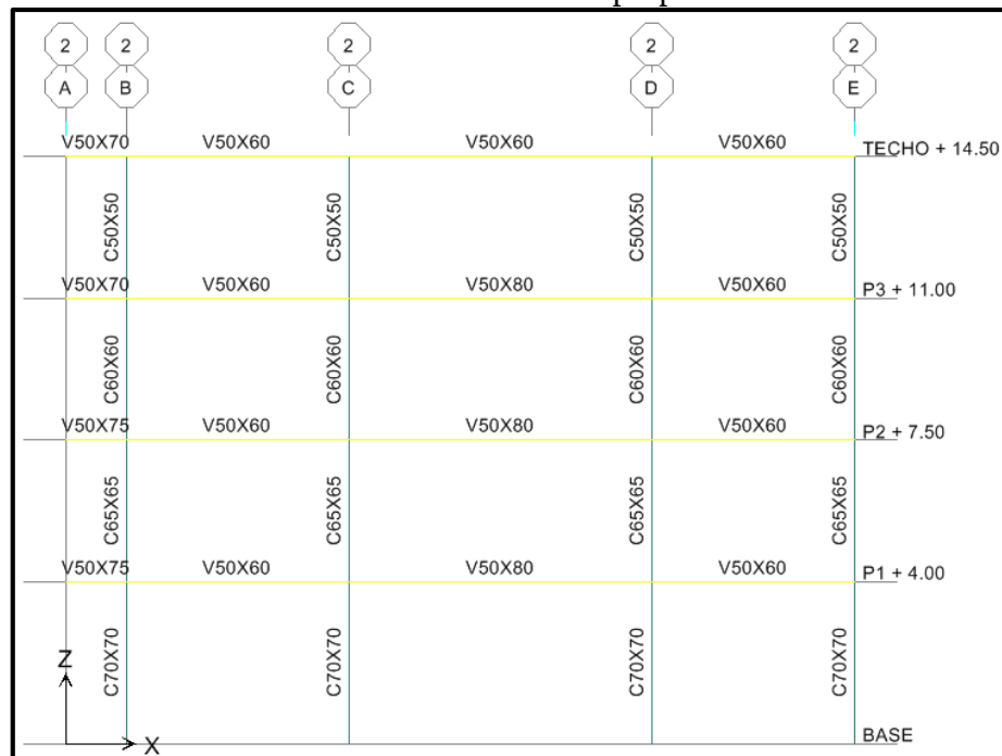
Figura 50. Secciones Finales de Columna (Pórtico 2) Fuente: Elaboración propia
