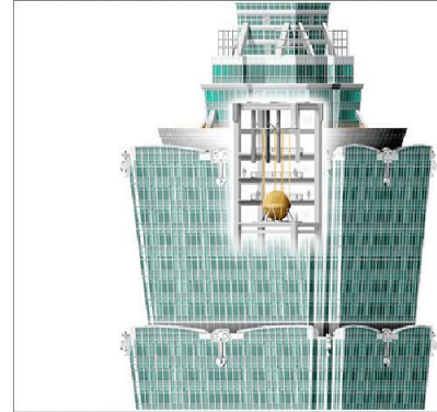
Fig. 22. Amortiguador de masa IHI. Fuente: antisismos.blogspot.com
