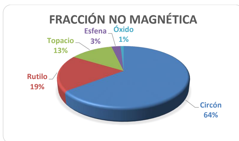
Figura 4.8. Porcentaje de minerales en la muestra Borbón roca no magnético.
