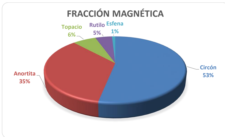
Figura 4.2. Porcentaje de minerales en la muestra Borbón detrítico magnético.
