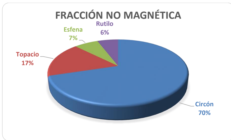
Figura 4.20. Porcentaje de minerales en la muestra Peñon Aro no magnético.
