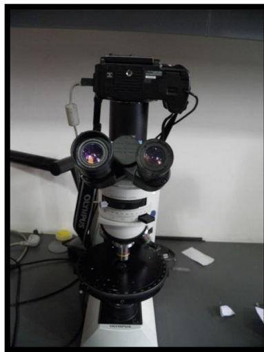
Figura 3.1. Microscopio petrográfico dotado de una cámara usada en este trabajo para el reconocimiento de minerales.
