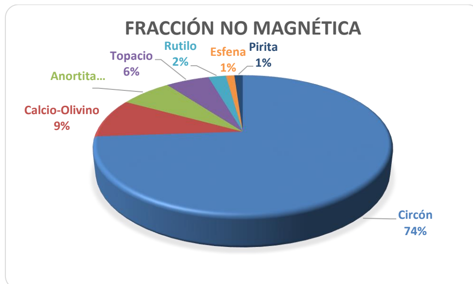
Figura 4.16. Porcentaje de minerales en la muestra Moitaco no magnético.
