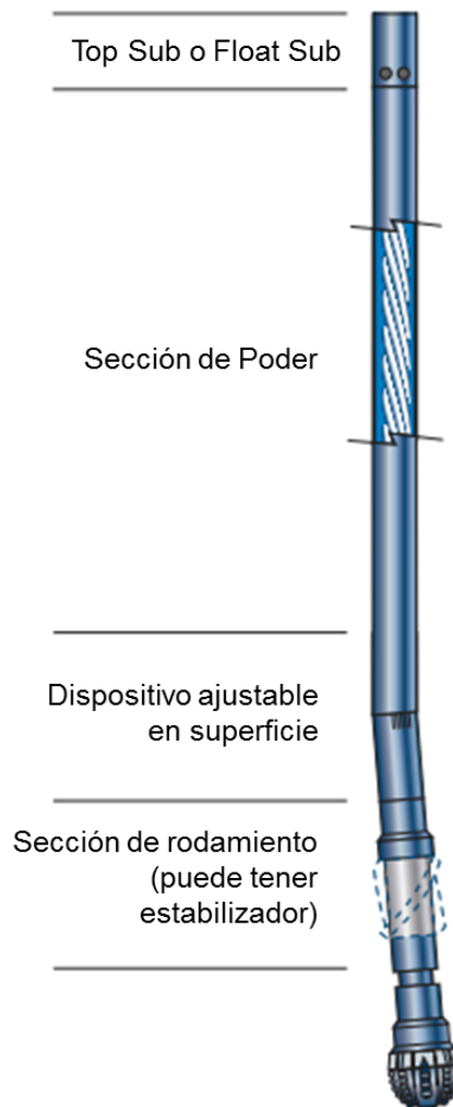
Figura 3. Partes de un motor PDM [6] . Modificado
