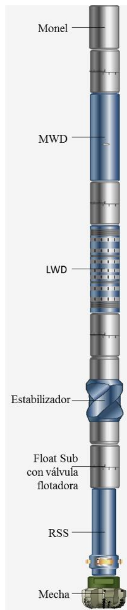
Figura 15. Ensamblaje de fondo usado en el B-05
