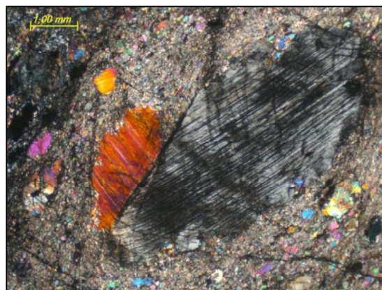
Figura D.58. Granulita máfica milonítica. Muestra Co-14-218A. Cristal maclado y alargado de Augita de más de 1cm de largo, visible sin uso del microscopio. Se observan las lamelas paralelas de exsolución de ortopiroxenos dentro de dicho cristal. Vista en nicoles cruzados.
