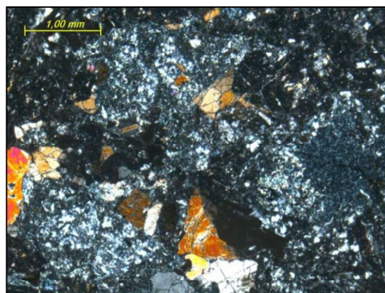
Figura D.13. Basalto augítico porfídico. Muestra Co-14-205AS. Cristales subhedrales de Augita y clinopiroxenos en proceso de cloritización. Vista en nicoles cruzados.
