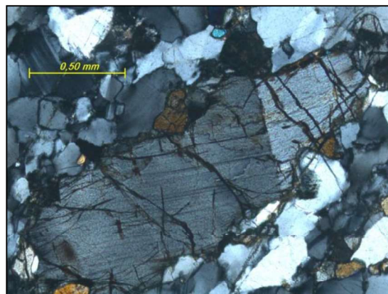
Figura D.48. Gneis granulítico granatífero-augítico-cuarzoso. Muestra Co-14-216DR. Cristal de augita con maclado polisintético. Vista en nicóles cruzados.
