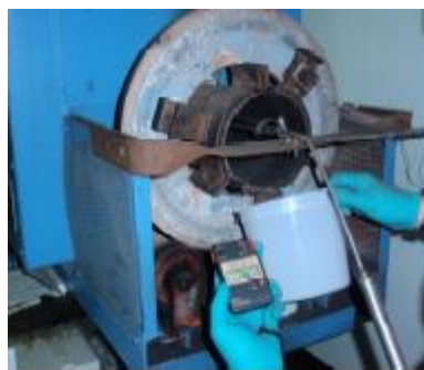
Figura N°12: Recolección de sólidos a la descarga del horno. Fuente: Procedimiento de operación del horno rotatorio Peña (2013)
