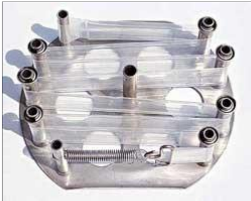
Figura 4. Dispositivo de Membrana Semipermeable (DMS) comercial [24] .
