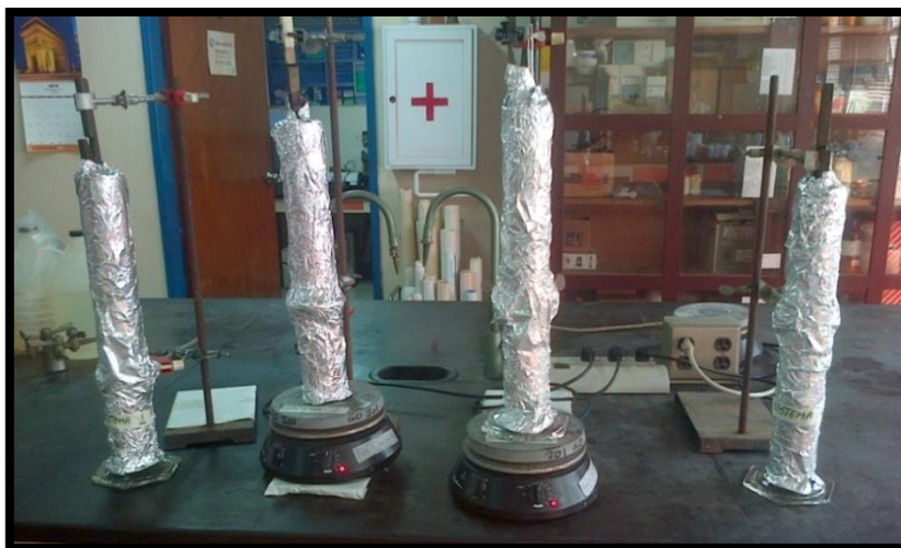
Figura 8. Fotografía de los montajes de la exposición de las membranas a la solución de estudio.
