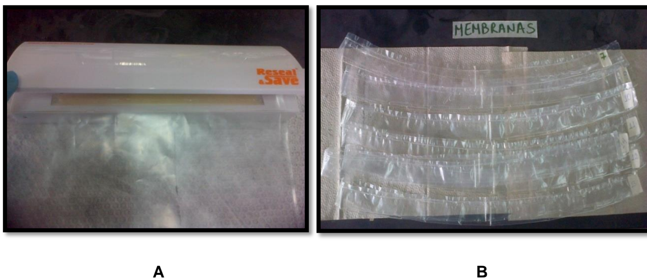
Figura 6. (A) Sellado de la membrana semipermeable; (B) Membranas rellenas con aceite de soya y selladas en ambos extremos.
