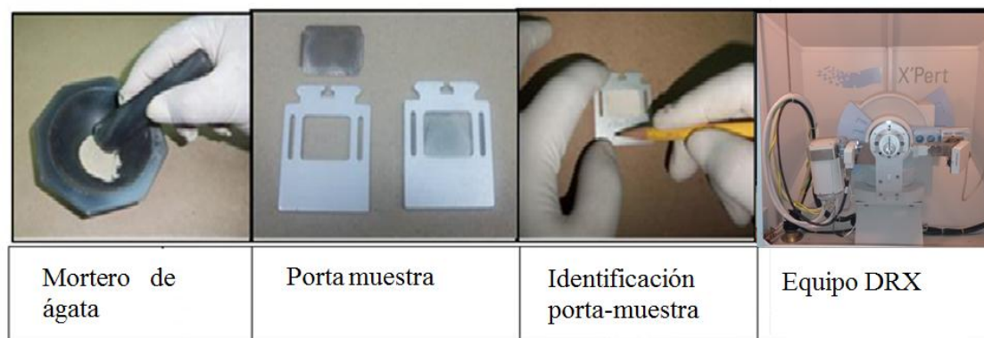
Figura 23. Procedimiento para el análisis por DRX (Laboratorio DRX PDVSA-INTEVEP 2014) (Tomado de Vera, 2014)
