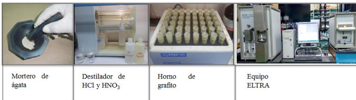
Figura 22. Preparación de la muestra para el análisis de COT y S (Laboratorio de espectroscopia atómica PDVSA-INTEVEP 2014) (Tomado de Vera, 2014)
