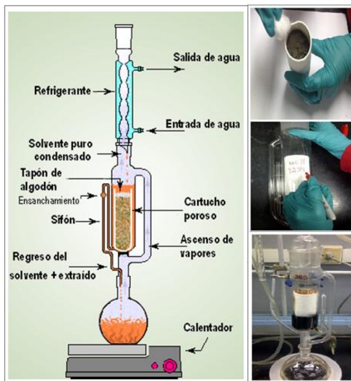
Figura 20. Sistema de extracción soxhlet (Laboratorio de geoquímica orgánica PDVSA-INTEVEP) (Tomado de Vera, 2014)
