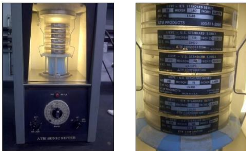
Figura 21. Equipo Tamizador ATM SONIC SIFTER (Laboratorio de difracción de rayos-x PDVSA-INTEVEP) (Tomado de Vera, 2014)
