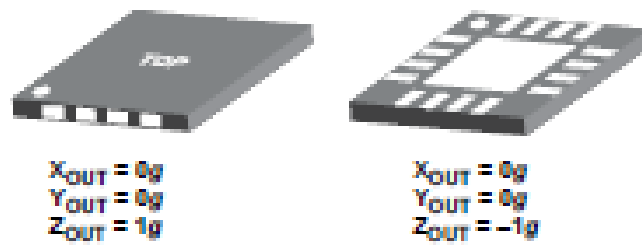
Figura 42: Aceleración en el eje Z [22]
