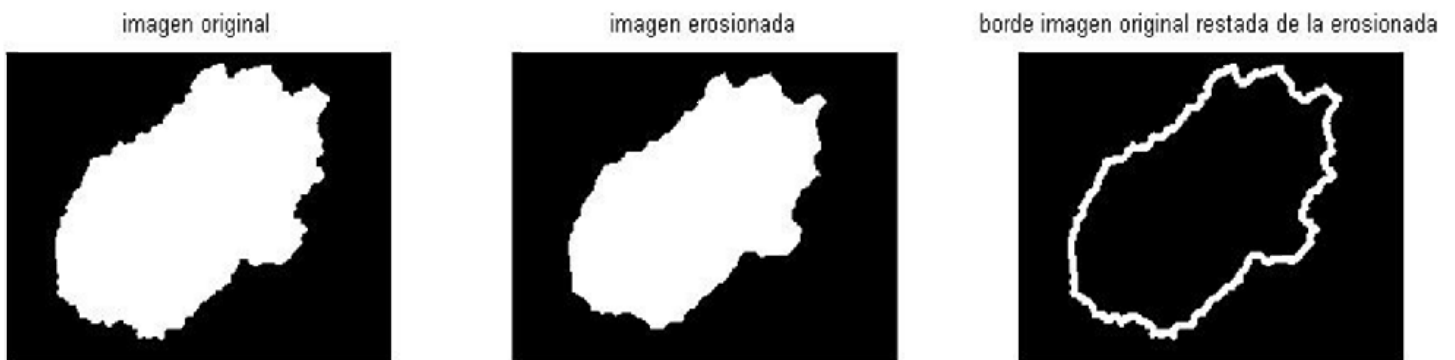
Figura 27: Foto 8 segmentada en binaria original y luego la original erosionada usando un disco de radio 15 como elemento estructurante. Por último, la imagen original restada a la erosionada respectivamente (Fuente: Dra. De Santis, UCV, Caracas Venezuela)
