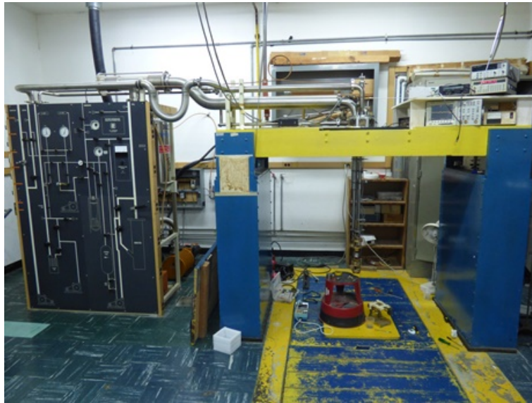
Figura 3.5: Refrigerador de Dilución y panel de control.
