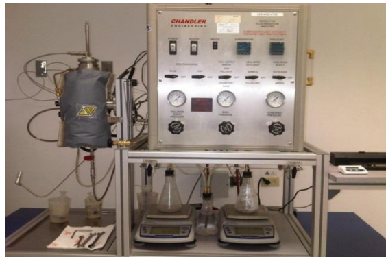
Figura 3. 8 Equipo analizador de migración de fluidos FMA. [Sardi, 2015]
