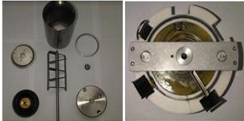
Figura 3. 8 Izquierda: partes de la copa de muestra. Derecha: consistómetro. [Sardi, 2015]
