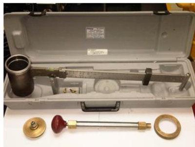
Figura 3. 3 Balanza Presurizada. [Sardi, 2015]
