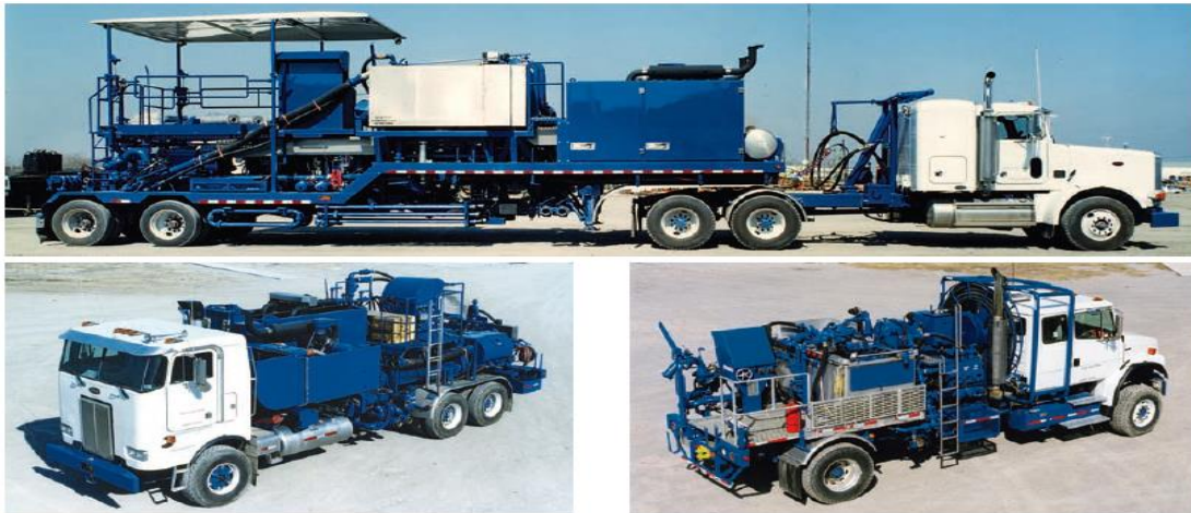
Figura 2. 4 Modelos de unidades de bombeo. [Nelson y Guillot, 2006]
