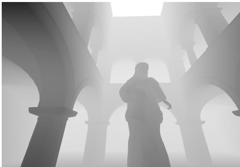
Figura 21. Representación gráfica de un mapa de profundidad utilizado para los cálculos de colisiones en espacio de pantalla
