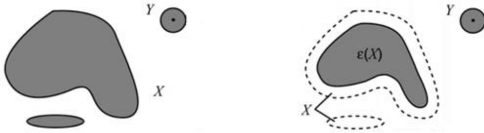
Figura 3.4. Erosión de X por el elemento estructurante Y . Los elementos conectados del conjunto X más pequeños que Y son eliminados.
