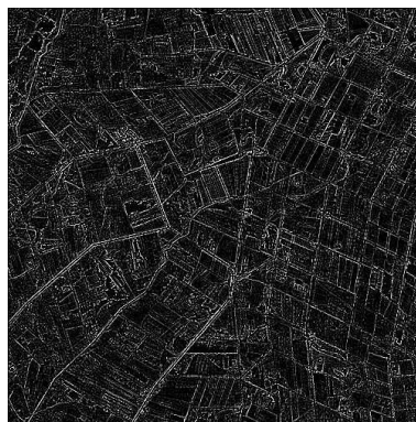
Figura 5.2. Detección de bordes mediante el filtro de Laplace.
