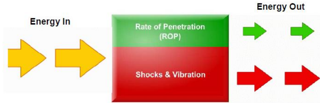
Fig. 2.32. Perforación problemática de baja ROP, con choques y vibraciones en exceso. [22]
