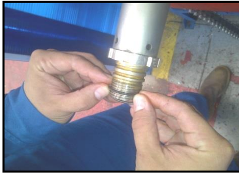
Figura 3. 38: Colocando las junta 3 [17]
