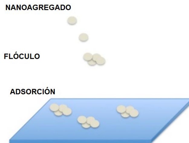
Figura 16. Esquema de adsorción de asfaltos propuesto por Castillo y col. [21]
