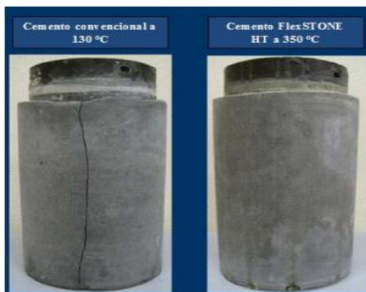
Figura 14: Comparación de la Resistencia a la Alta Temperatura entre el Cemento Convencional y el FlexStone (21)
