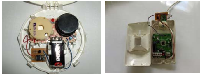
Sensor de incendio y sensor de presencia
