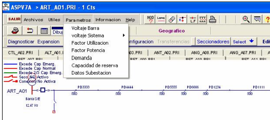
Figura 5.14. Barra de selección del voltaje de la subestación.
