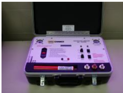
Figura 6.5. Equipo probador de puesta a tierra.
