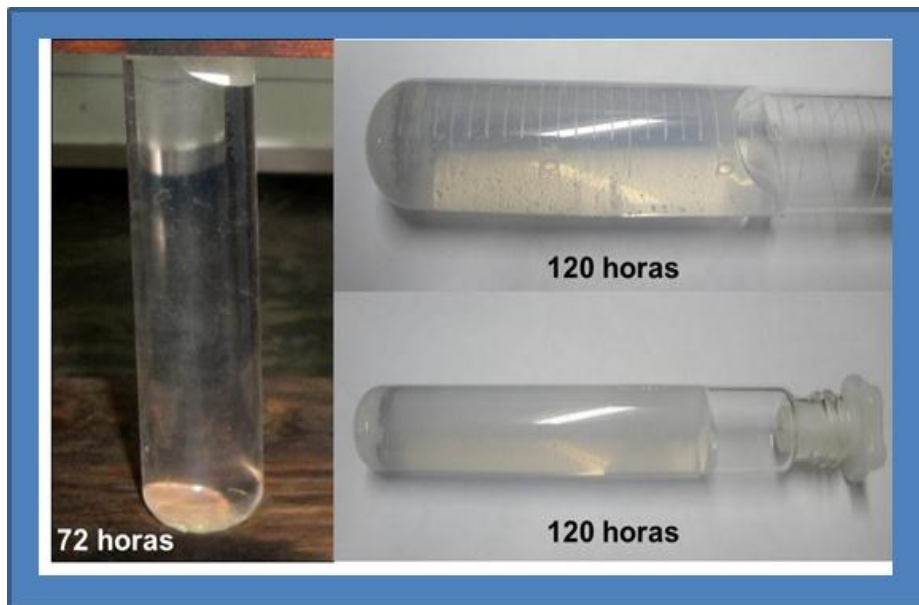
Figura 21. Efecto del tiempo de gelación en la preparación de los xerogeles de silicio
