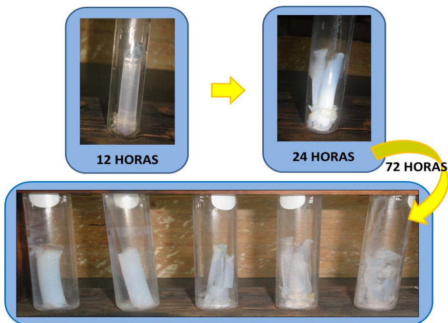
Figura 22. Efecto del tiempo y la temperatura de secado en xerogeles modificados con plomo
