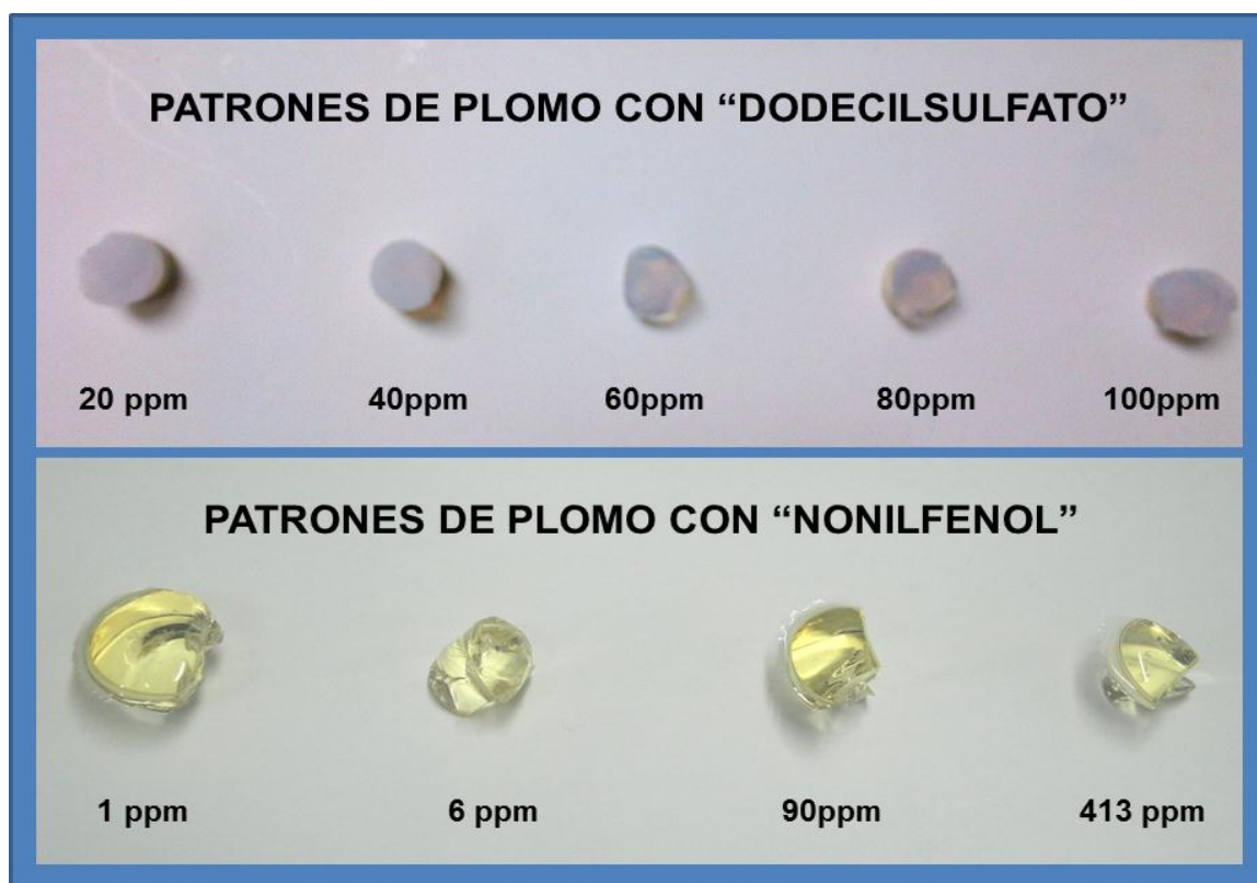
Anexo d. Xerogeles de silicio modificados con plomo, utilizando diferentes surfactantes.
