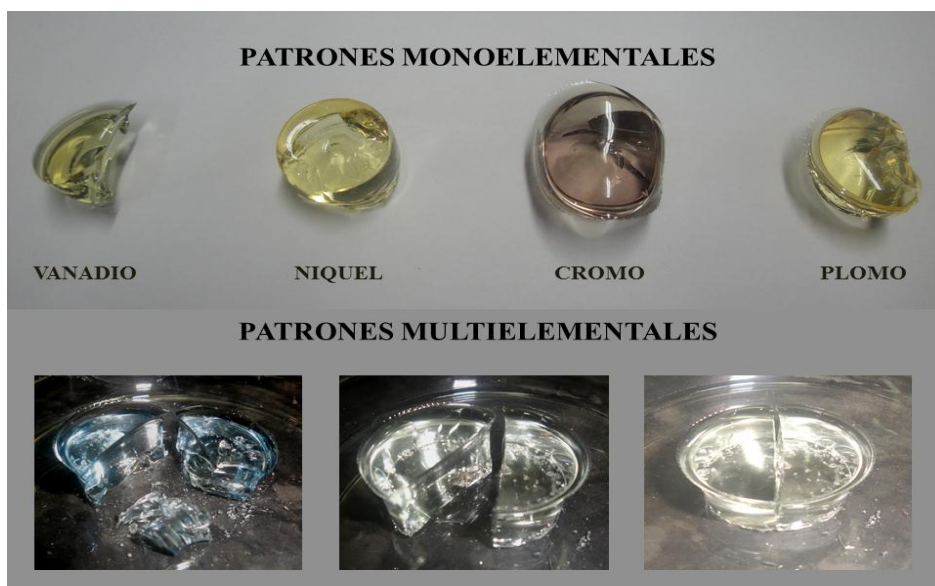
Figura 17. Xerogeles de silicio modificados con Cr, V, Ni y Pb (patrones secos, monoelementales y multielementales).
