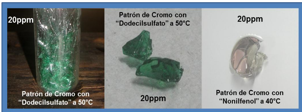
Anexo e. Xerogeles de silicio modificados con Cromo, utilizando diferentes surfactantes y a diferentes temperaturas de secado.
