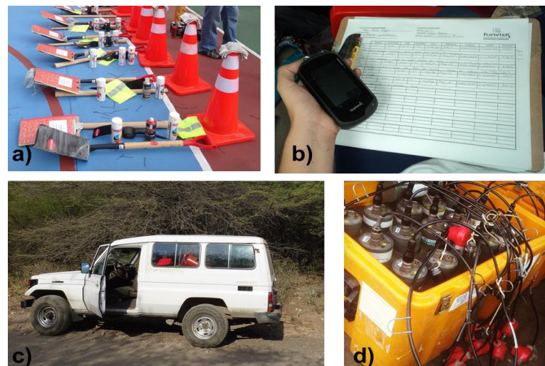
Figura 4.3. Herramientas para la adquisición de un perfil en tierra. a) picos, palas, conos de seguridad, sprays de colores, guantes; b) GPS de mano y planillas de registro; c) vehículo de transporte y d) caja de 15 Texans y geófonos de componente vertical.
