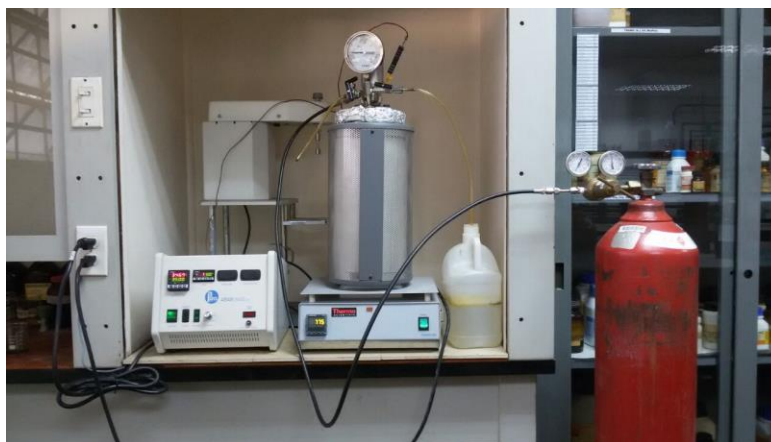
Figura N° 7. Montaje del sistema de reacción de VGO para sólidos catalítico
