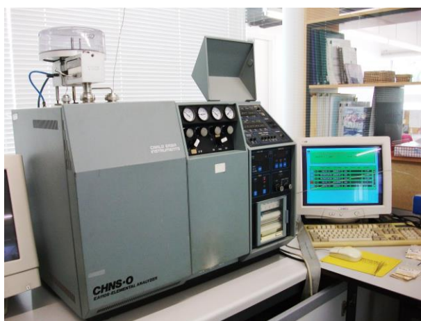
Figura N° 5. Analizador elemental CNHS-O modelo EA-1108- marca Carlo Erba.
