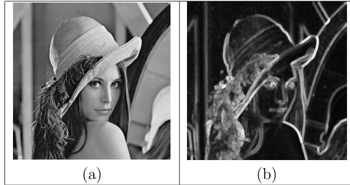
Figura 3.12: (a) Imagen original. (b) Imagen gradiente.
