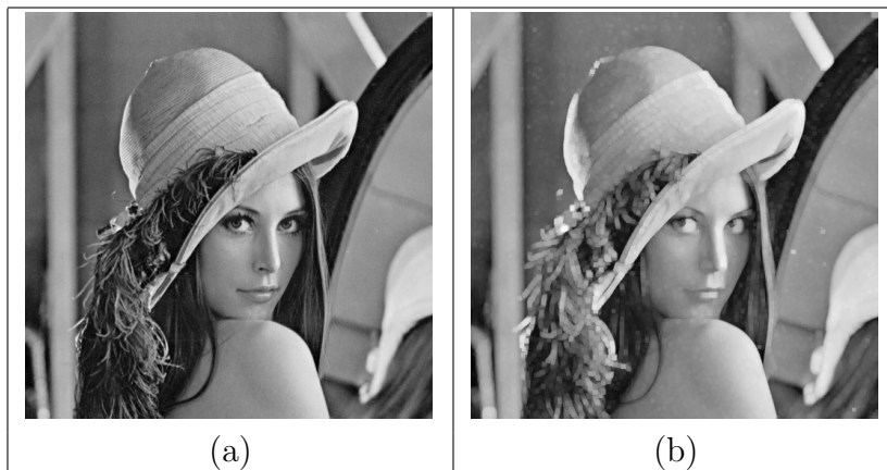
Figura 3.3: (a) Imagen original. (b) Imagen dilatación.
