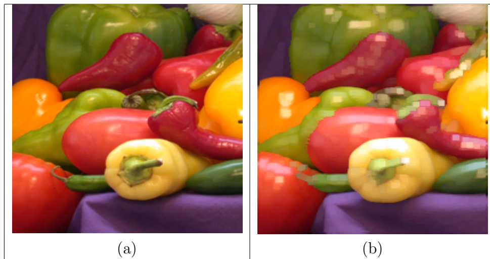
Figura 6.2: (a) Imagen original. (b) Imagen dilatada.
