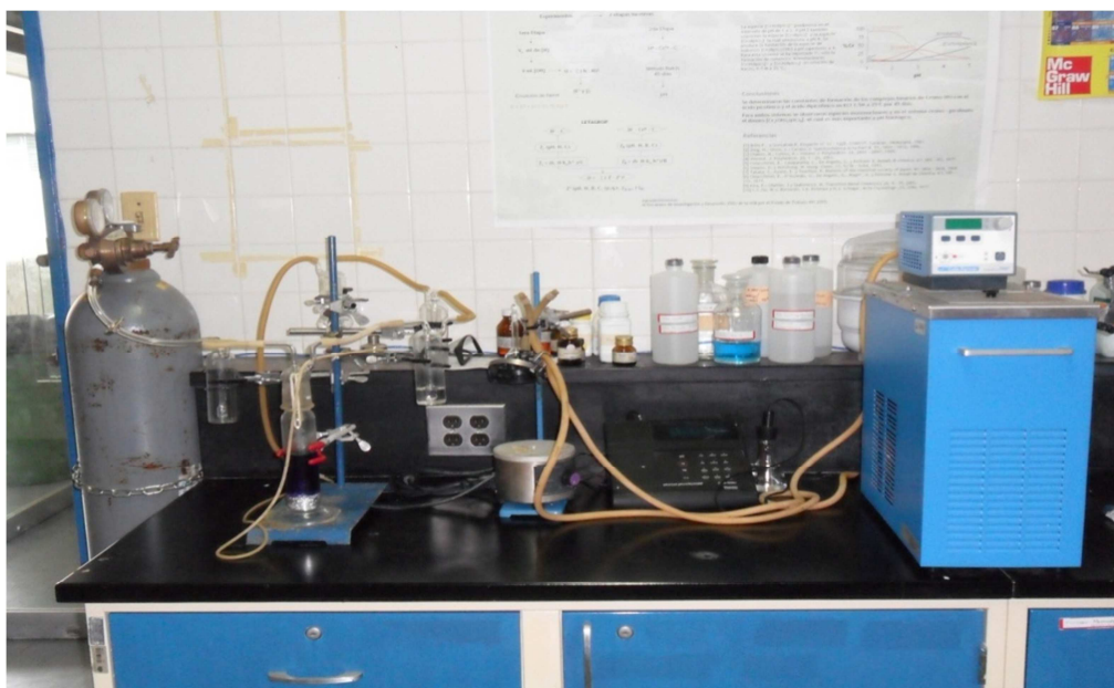
Figura 11. Equipo de medidas de emf(H) empleado.
