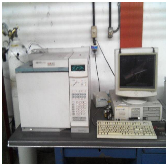
Figura 5. Cromatógrafo de Gases empleado para el seguimiento de las reacciones de HDS, HDN e hidrogenación
