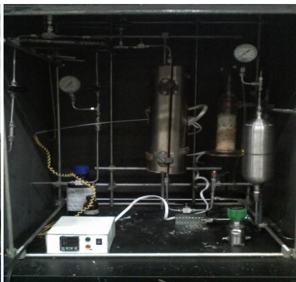
Figura 6. Equipo de Hidrotreatmento utilizado para el ensayo de las reacciones de HDN, HDS e hidrogenación
