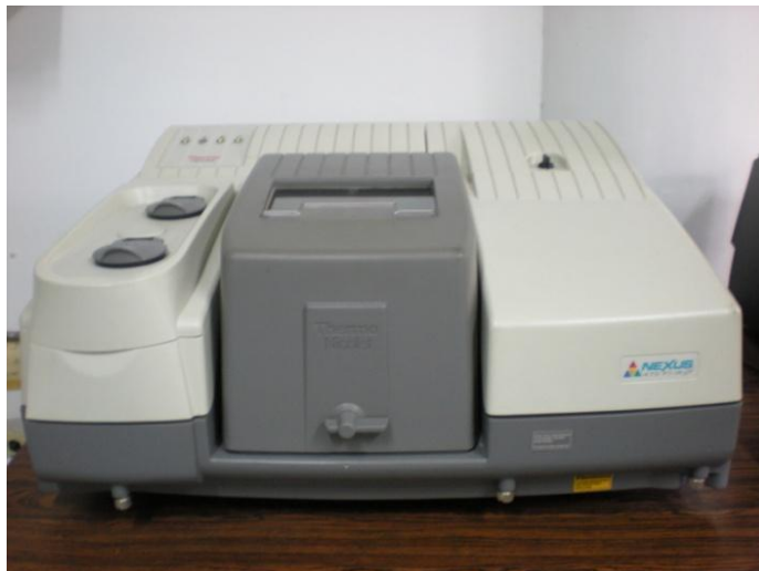
Figura 17. Equipo IRFT Nexus 470 Thermo Nicolet (Análisis de Espectroscopía de Infrarrojo).
