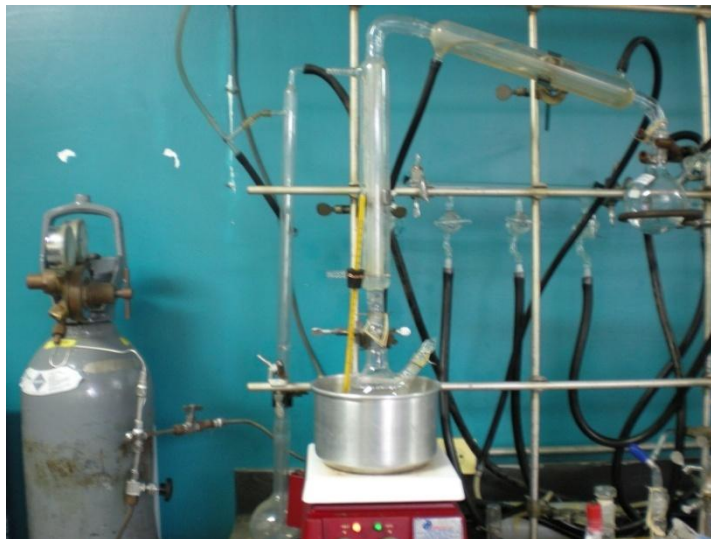
Figura 16. Montaje realizado para la destilación de los solventes bajo atmósfera inerte.
