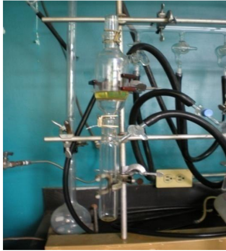
Figura 21. Montaje realizado para la filtración del producto empleando el embudo de placa porosa.
