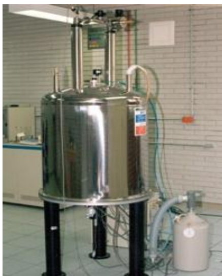
Figura 18. Equipo JEOL superconducting magnet 270MHz. (Análisis RMN).
