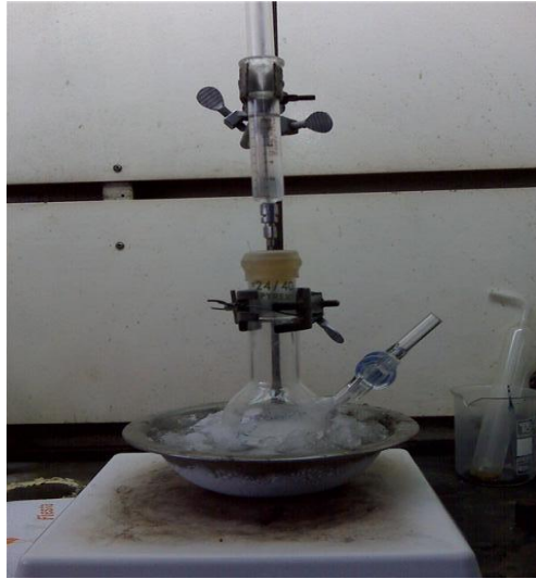
Figura 19. Montaje realizado para la síntesis del TMS.
