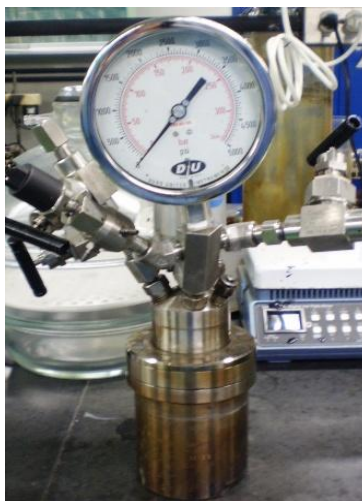
Figura 26. Reactor electroquímico marca Parr de capacidad 1000 mL.
