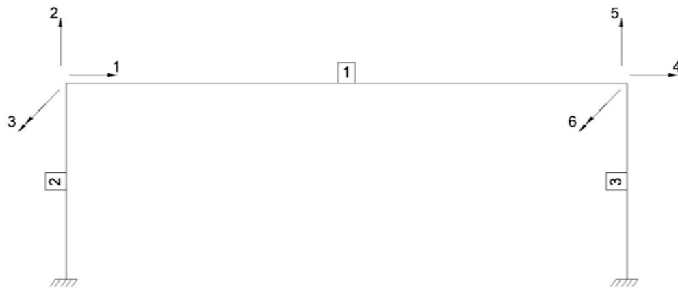
Figura VIII-2. Grados de libertad globales de la estructura
