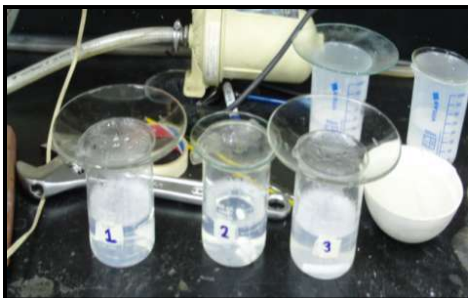
Figura 35. Beacker que contenían los geles SBA-15 (a 40°C funcionalizados por el método de Co-Condensación) con 3-aminopropiltietoxisilano.
