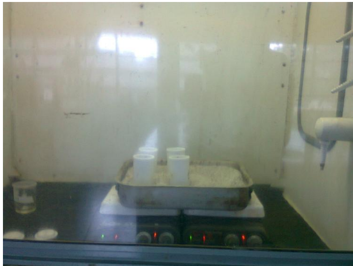
FIGURA Nº 16 Fotografía de los envases de teflón dentro de la campana utilizados en la digestión de las muestras de sedimentos antárticos.
