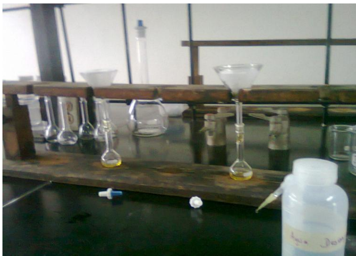
FIGURA Nº 17 Fotografía del Montaje empleado en el momento de filtrar y enrrasado en balones de 50 mL de las soluciones producto de la digestión ácida de las muestras.
