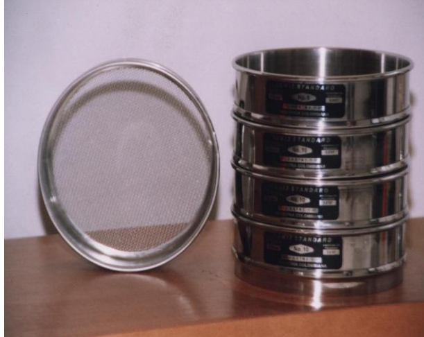
Figura № 14._ Tamices empleados en la separación granulométrica [3] .
